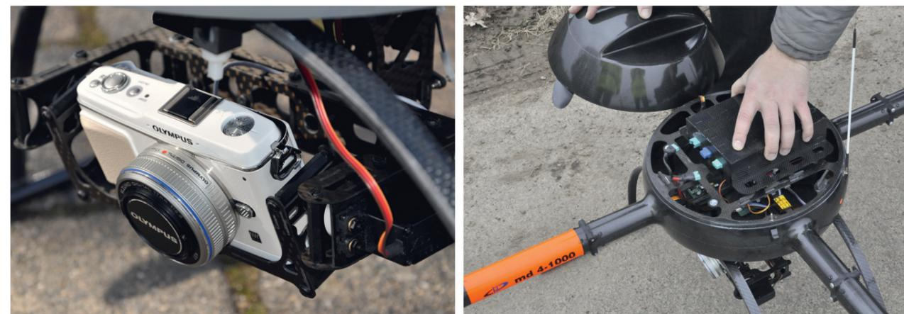
Abb. 2: Links: Systemkamera Olympus PEN (12,3 Megapixel, Sensortyp: Live MOS / 17,3 x 13,0 mm) und lichtstarkem 17 mm F2.8 Festbrennweitenobjektiv, Rechts: Der Akku der Flugplattform befindet sich unter einer abnehmbaren Schutzhaube und kann schnell gewechselt werden.
