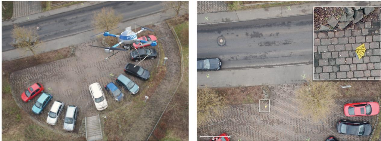
Abb. 5: Links: Microdrones md4-1000 im Anflug auf ein Monobild. Rechts: Die dazu gehörige Entzerrung, aufgenommen aus einer Höhe von 8.1 m mit Vergrößerung eines Details. Die Detailtreue spricht für sich. (Alle Abbildungen: Koll)
