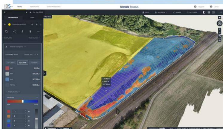
Der Auf- und Abtrag im Rahmen von Erdarbeiten kann sehr genau quantifiziert und visualisiert werden.
