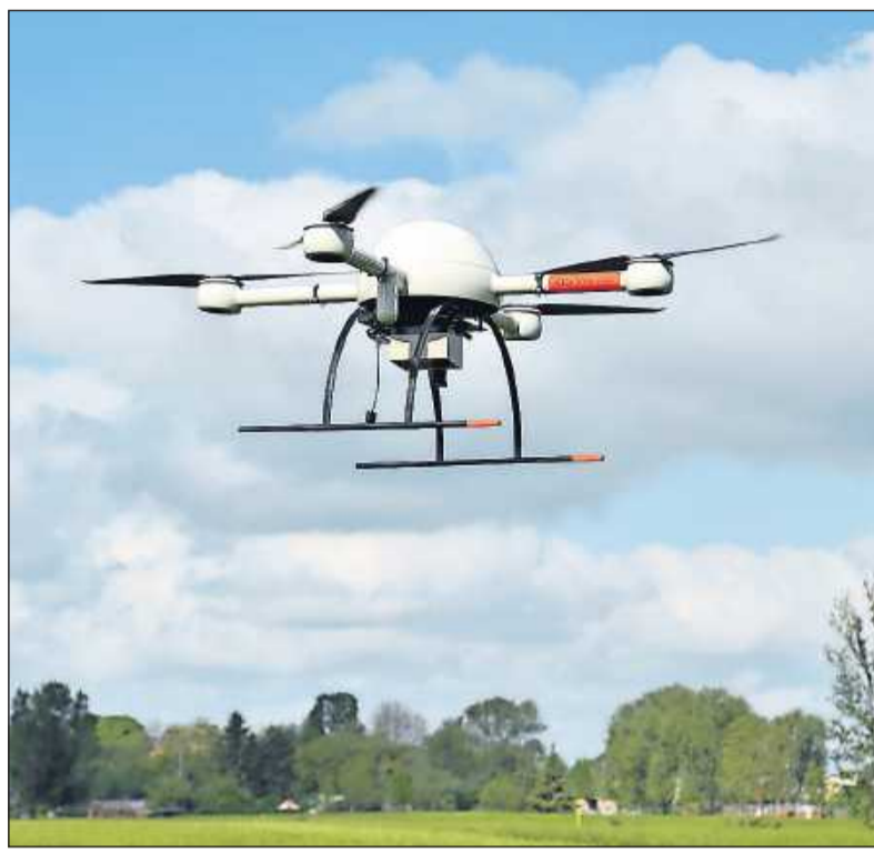
Mit einem Laserscanner ausgestattet, liefert die neue Drohne des Helmholtz-Zentrums (oben) sehr genaue 3-D-Bilder, etwa den Laserscan eines Buchenwaldes (unten). Die Drohne kann aber auch mit einer hochauflösenden Fotokamera oder einer Multispektralkamera bestückt werden.
